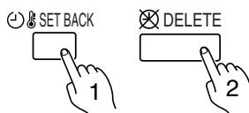
Нажмите кнопку SET BACK, а затем кнопку DELETE до появления индикатора подтверждения режима SET BACK. Даже при повторном нажатии кнопки SET BACK таймер режима специальной температуры SET BACK будет отключен.
